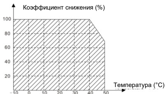
Рисунок 3-2. Снижение номинальной мощности ПЧ.
